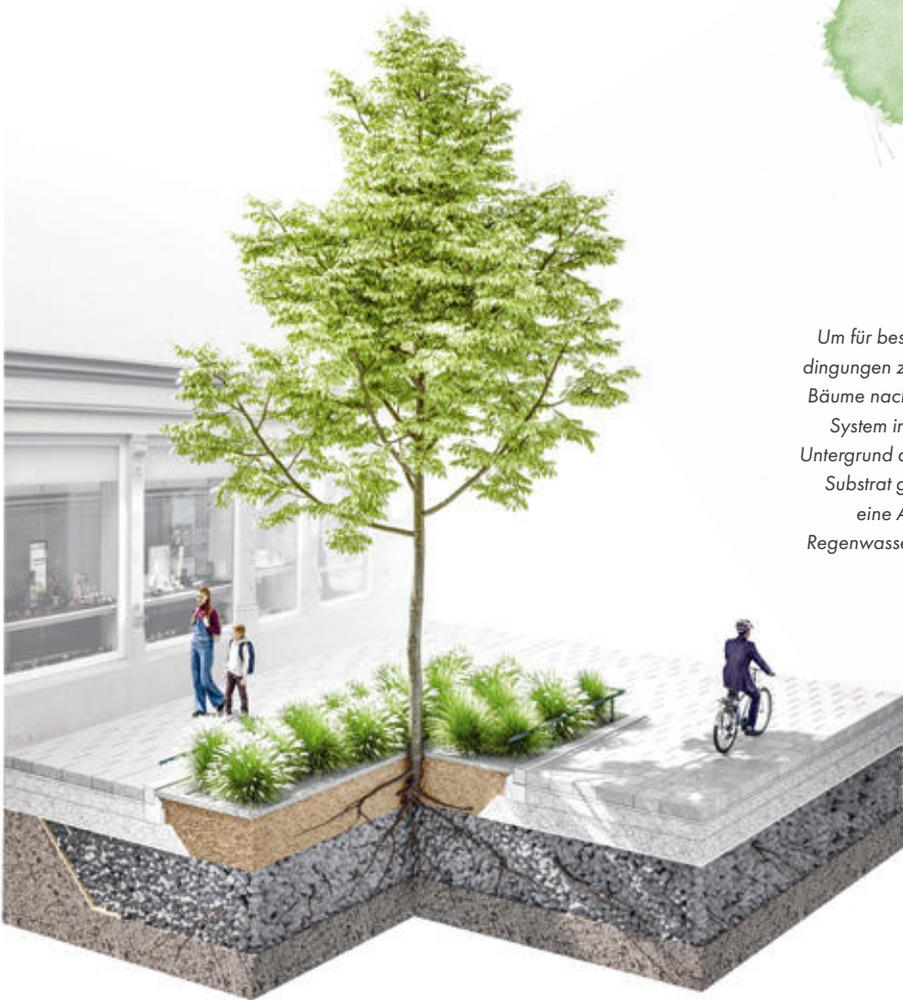
Um für beste Wachstumsbedingungen zu sorgen, werden Bäume nach dem Stockholm-System in einem speziellen Untergrund aus durchlässigem Substrat gesetzt. Das ergibt eine Art Schwamm, der Regenwasser aufnehmen und speichern kann.
