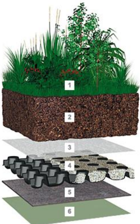
Abbildung 42: Aufbau - Intensivbegrünung (DACHUNDGARTEN o.J.)
