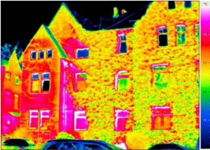
Abbildung 50: Oberflächentemperaturen einer begrünten (rechts) und unbegrünten Hauswand (Foto: Mersmann in KUTTLER et al. 2012)
